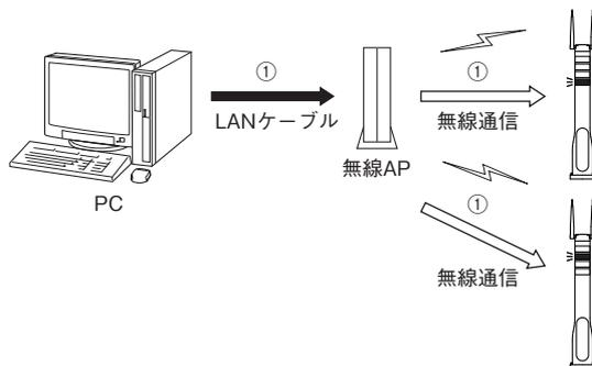
■例3：パソコンとリモートI/O間を有線通信、無線通信（ブリッジ機能）経由で接続
