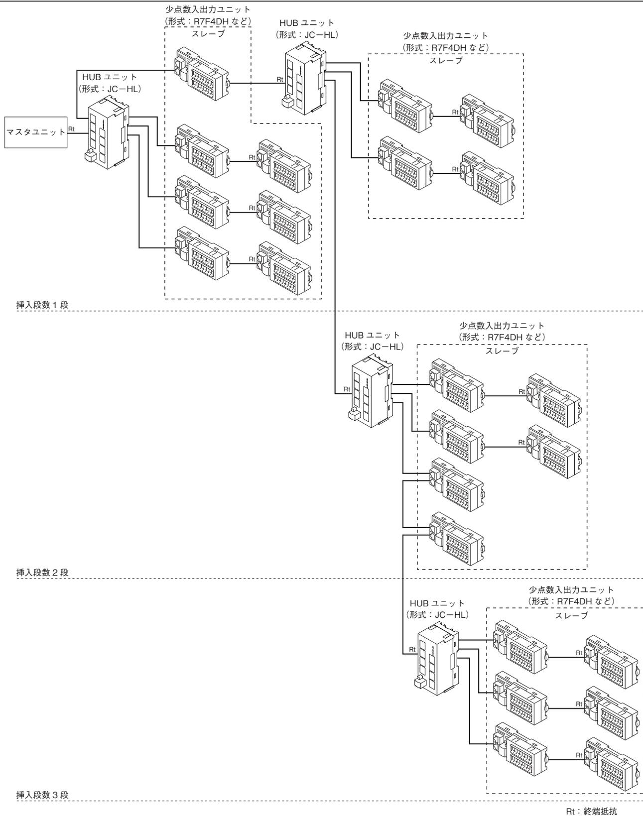
注 1) マスターユニットと HUB ユニット間、HUB ユニットと HUB ユニット間、HUB ユニットとスレーブユニット間の最大通信距離は、12Mbps 時 100m、6Mbps 時 200m、3Mbps 時 300m となります。
