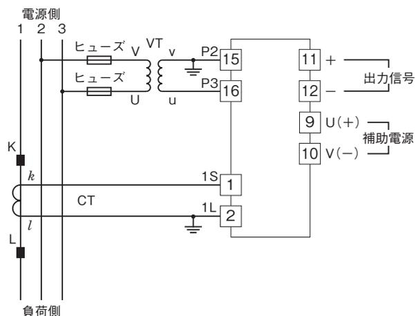
入力電圧が比較的安定しており、仕様書または取扱説明書に記載された補助電源電圧の範囲内であれば、入力電圧からの電源供給が可能です。
