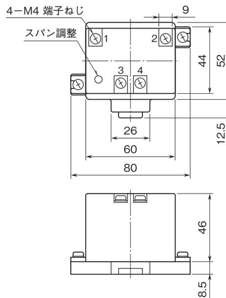
取付寸法図(単位:mm)
