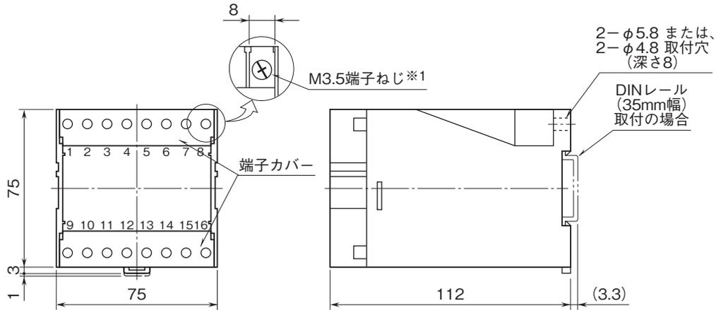
※1、端子ねじの配置は、端子接続図を参照して下さい。
