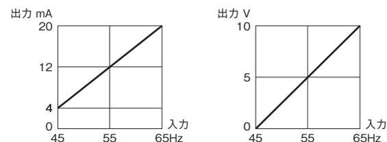
入力電圧が無電圧の場合、出力が(-)側振り切れとなります。
