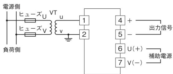
入力電圧が比較的安定しており、仕様書または取扱説明書に記載された補助電源電圧の範囲内であれば、入力電圧からの電源供給が可能です。
