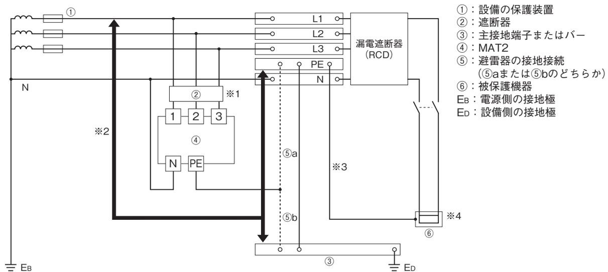
※1、遮断器は必ず設置して下さい。遮断器は配線用遮断器、漏電遮断器（OC付）のいずれでも構いません。
