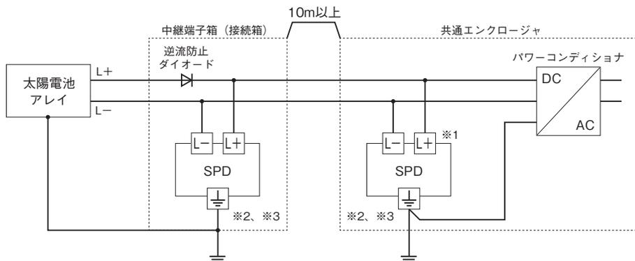
※1、中継端子箱に設置した避雷器とパワーコンディショナの配線距離が10m以上ある場合は、パワーコンディショナの近くにも本器を設置して下さい。
