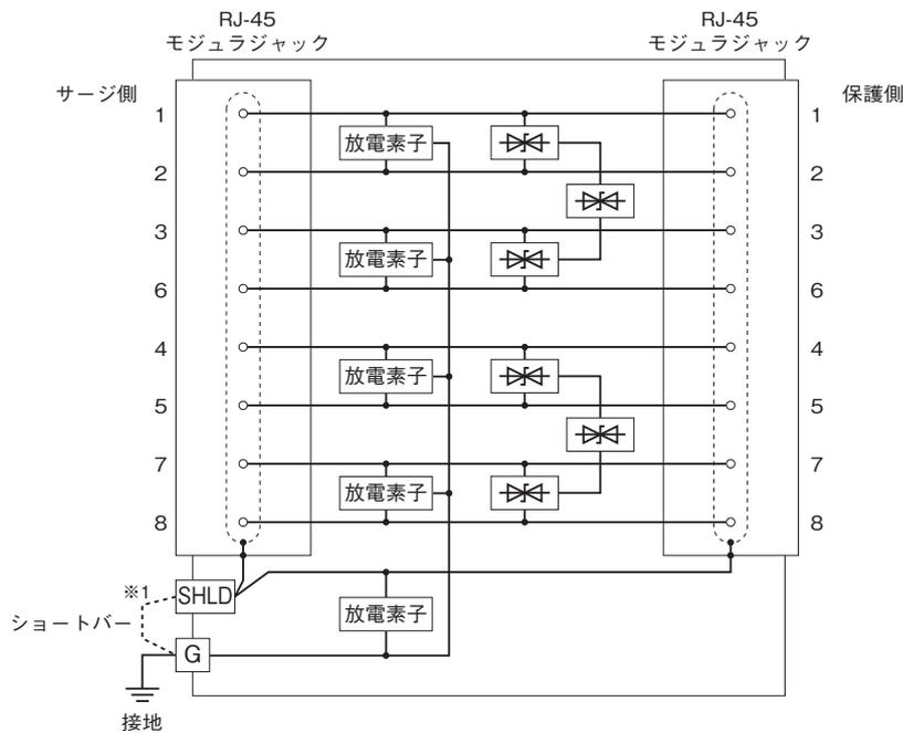
※1、LANケーブルのシールド線をフローティングする場合は、ショートバーを取外して下さい。
