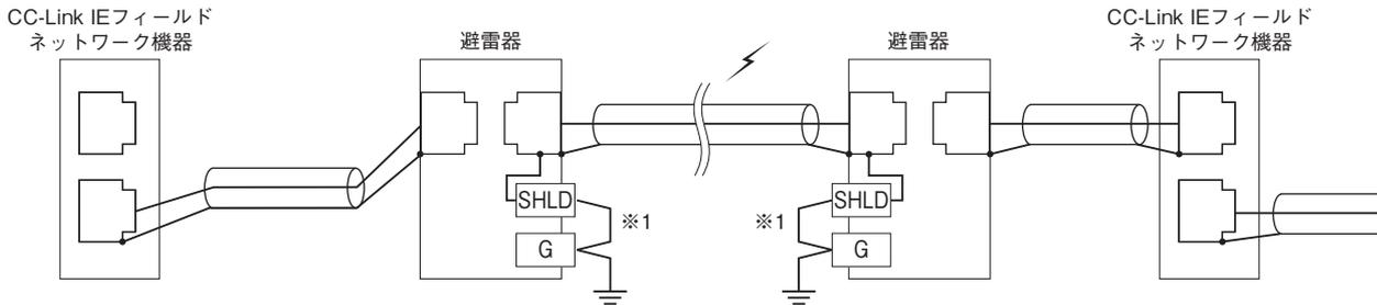
※1、ショートバーが取付られているときは、LANケーブルのシールド (SHLD) はグラウンディング状態です。
