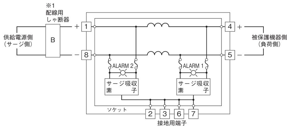
※1、配線用しゃ断器は必ず設置して下さい。
