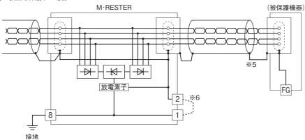
※5、LANケーブルのシールド線(付属品)が連接接地を兼ねます。
