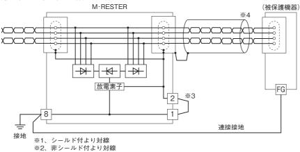
※3、ショートバーを取付けた状態でご使用下さい。被保護機器はグランディング状態です。 ※4、付属ケーブル
