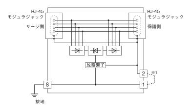
※1、LANケーブルのシールド線をフローティングする場合は、 ショートバーを取外して下さい。
