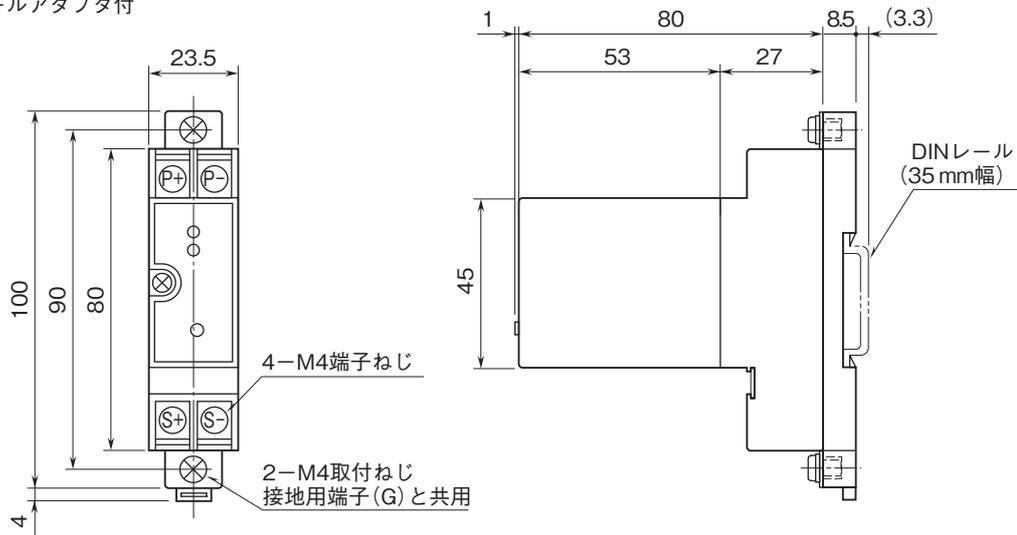
取付寸法図(単位:mm)
