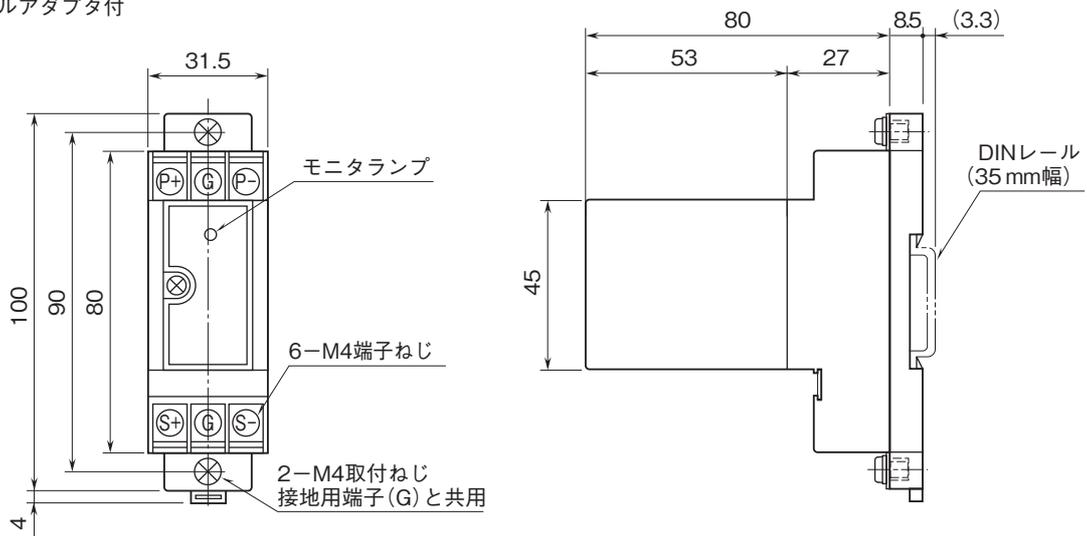
取付寸法図(単位:mm)
