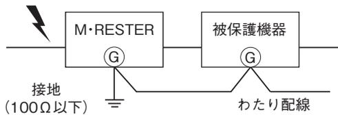
被保護機器のきょう体とM・RESTERの接地用端子を必ずわたり配線して下さい。
