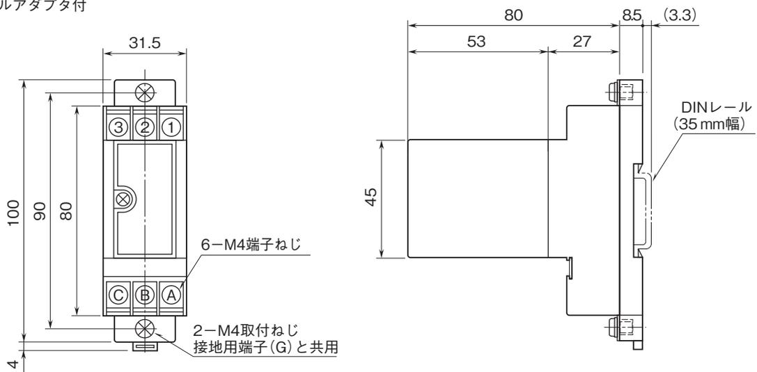
取付寸法図(単位:mm)
