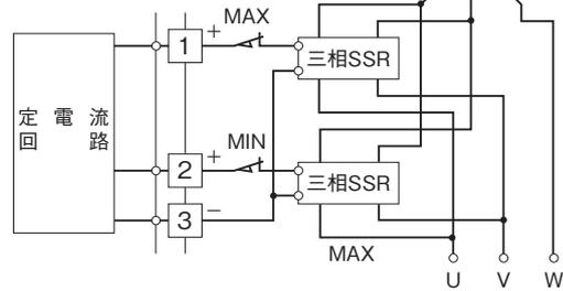
開度フィードバック信号接続例
