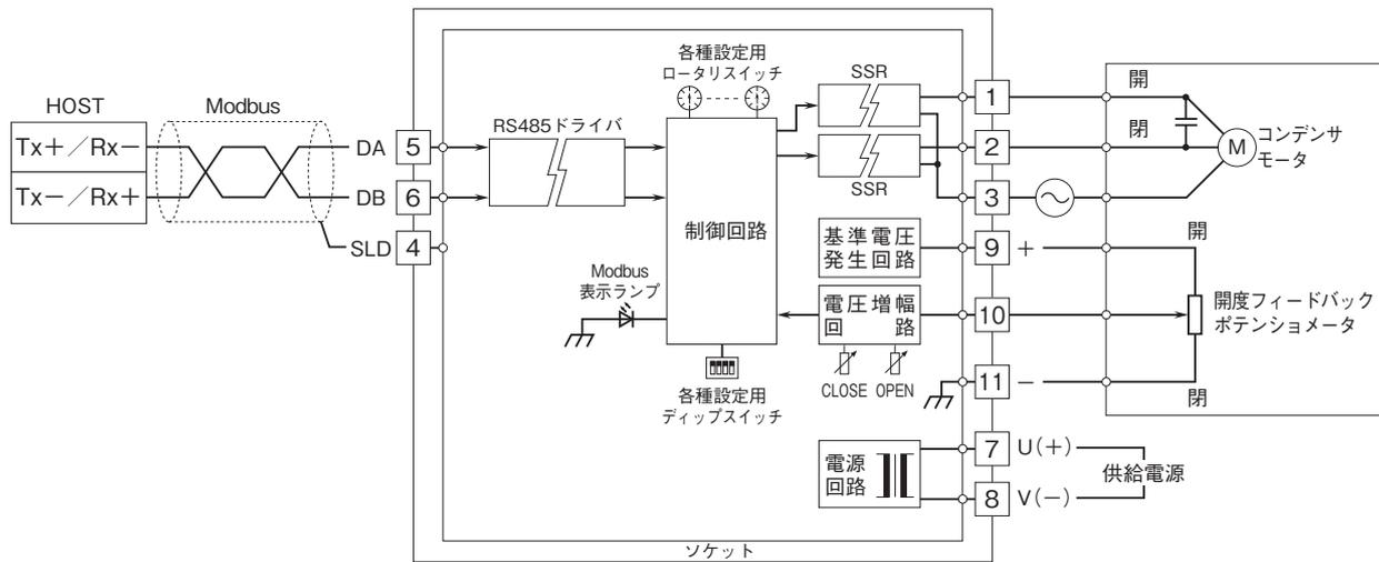
注) リミットスイッチを介してモータ結線をした場合、スイッチが動作する度にSSRに過度のストレスがかかる可能性がありますのでご注意ください。
