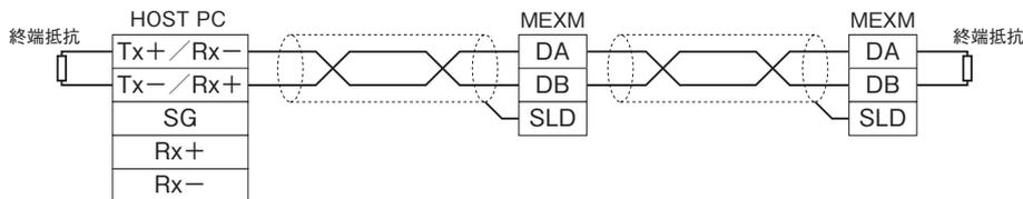
両端のユニットには、“DA” - “DB” 間に“終端抵抗”を接続して下さい。
