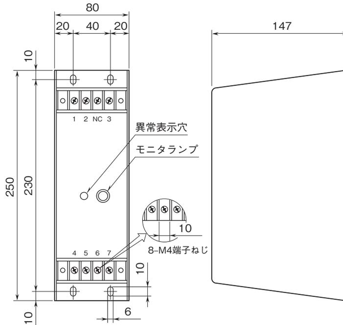
取付寸法図(単位:mm)
