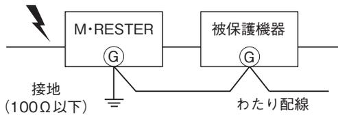
被保護機器のきょう体とM・RESTERの接地用端子を必ずわたり配線して下さい。
