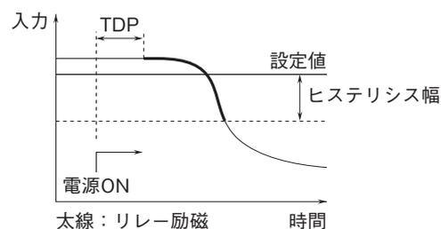
■動作遅延：警報状態になってから、出力リレーが動作するまでに遅れ時間TDを要します。警報またはリセット状態をTDの時間以上保持しないと、出力リレーの状態は変化しません。
