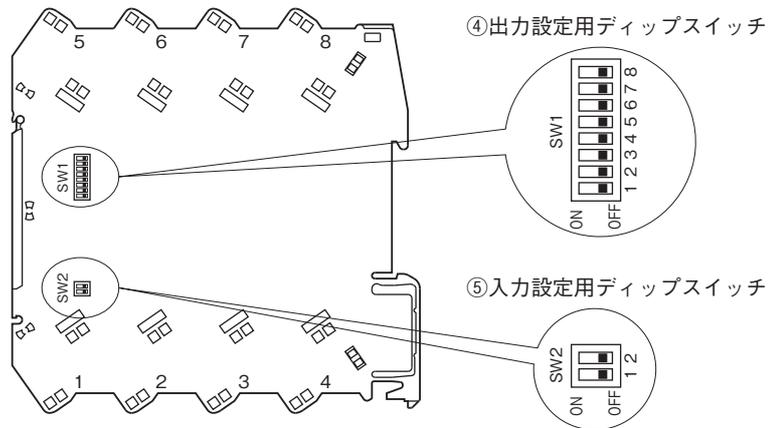
入出力の種類の切替には、PCによるコンフィギュレーションに加えてディップスイッチの設定が必要です。
