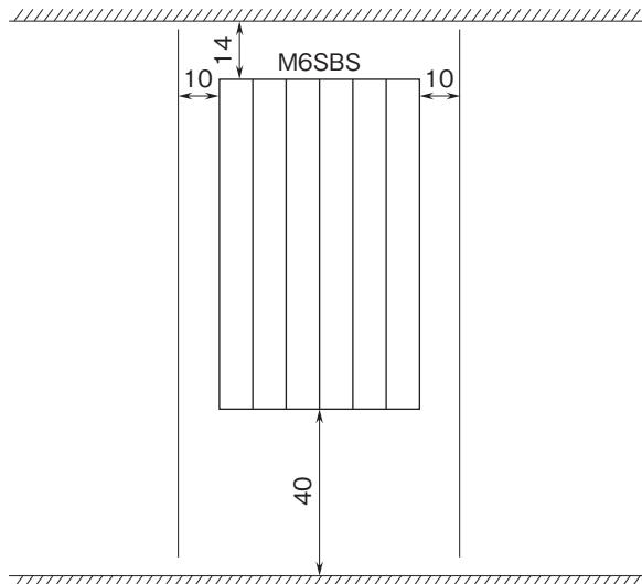
盤の底板、配線ダクト（高さ50mm以下）を示す。
