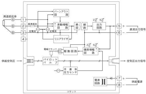
注)電流出力の場合は必ず負荷を接続して下さい(負荷を接続しないときは、出力端子⑤一⑥間を短絡して下さい)。
