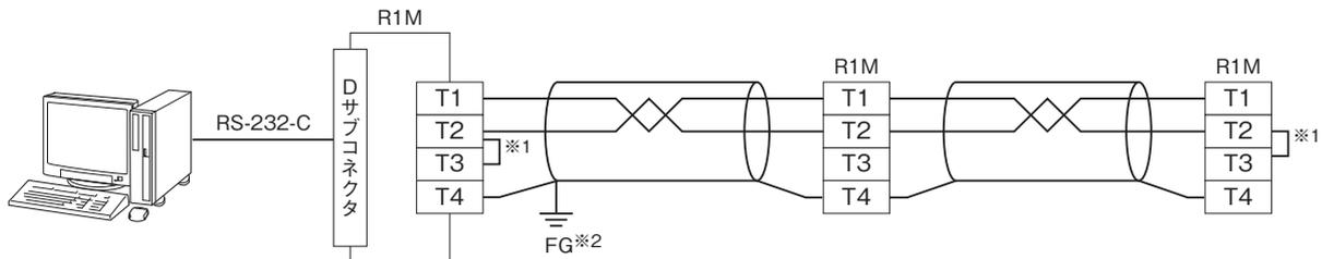
※1、回路の終端となる場合に、内部の終端抵抗を使用します。
