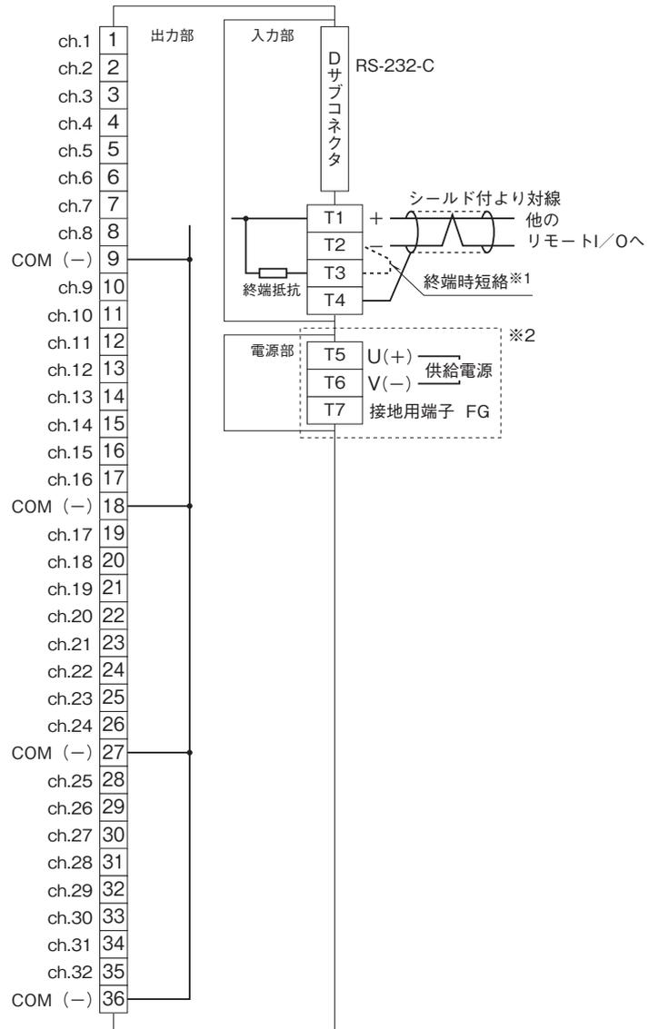
※1、より対線の伝送ラインが終端の場合は (= 渡り配線がない場合)、端子T2、T3間を付属のショートチップ (または配線) で短絡して下さい。
