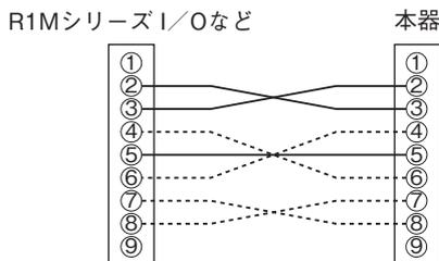
実線と破線による接続はインターリンクケーブル使用例です。
