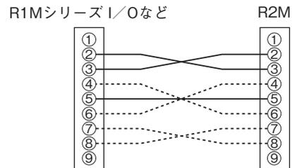
実線と破線による接続はインターリンクケーブル使用例です。
