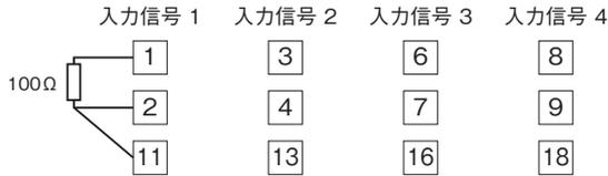
未使用の入力端子に抵抗器が接続されていない場合、ERR表示ランプが赤色に点灯し、PLC等にバーンアウトフラグがセットされます。コンフィギュレータソフトウェア（形式：R3CON）を用いることにより、未使用入力の処理を行わずに、未使用入力の設定が可能です。
