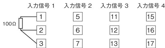
未使用の入力端子に抵抗器が接続されていない場合、ERR表示ランプが赤色に点灯し、PLC等にバーンアウトフラグがセットされます。
