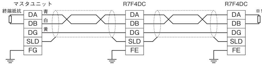
※1、内蔵の終端抵抗を使用する場合、終端抵抗設定用スイッチをONにして下さい。
