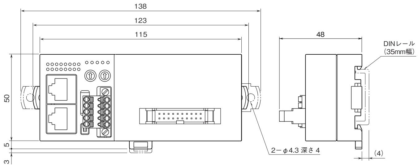
取付寸法図(単位:mm)
