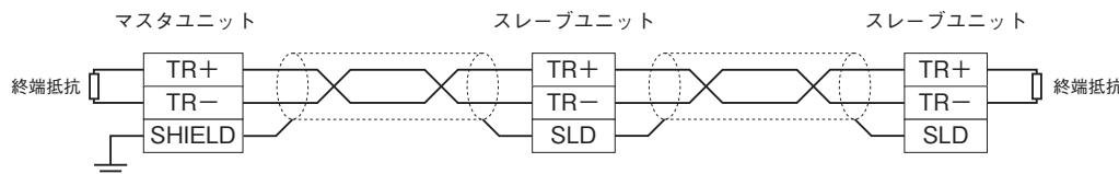
注) 両端のユニットには、必ず終端抵抗設定用スイッチをONにして下さい。
