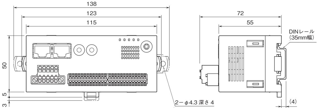
取付寸法図(単位:mm)
