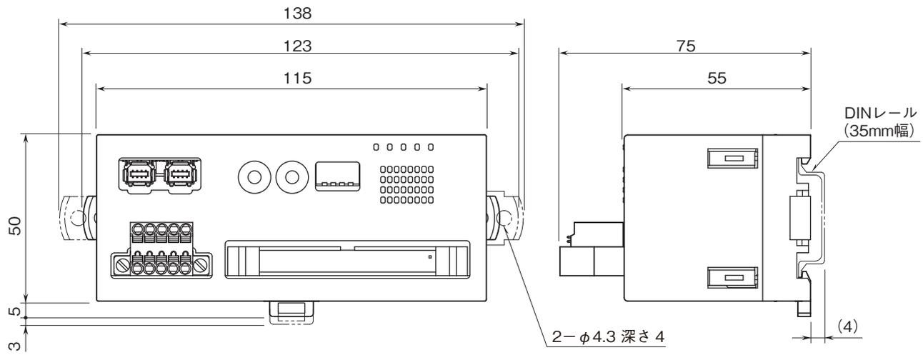
取付寸法図(単位:mm)
