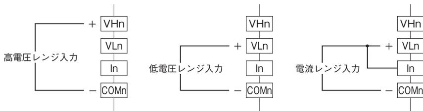
注) 直流電流入力時は必ずVLnとIn端子を短絡してご使用下さい。
