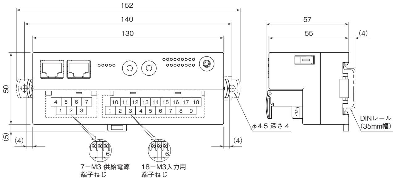
取付寸法図(単位:mm)
