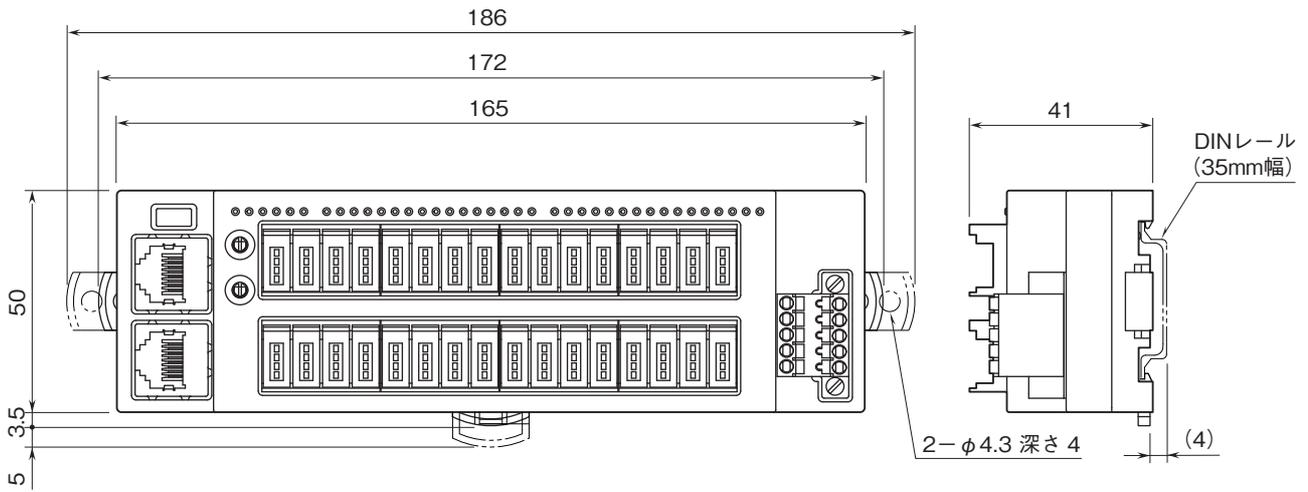
取付寸法図(単位:mm)
