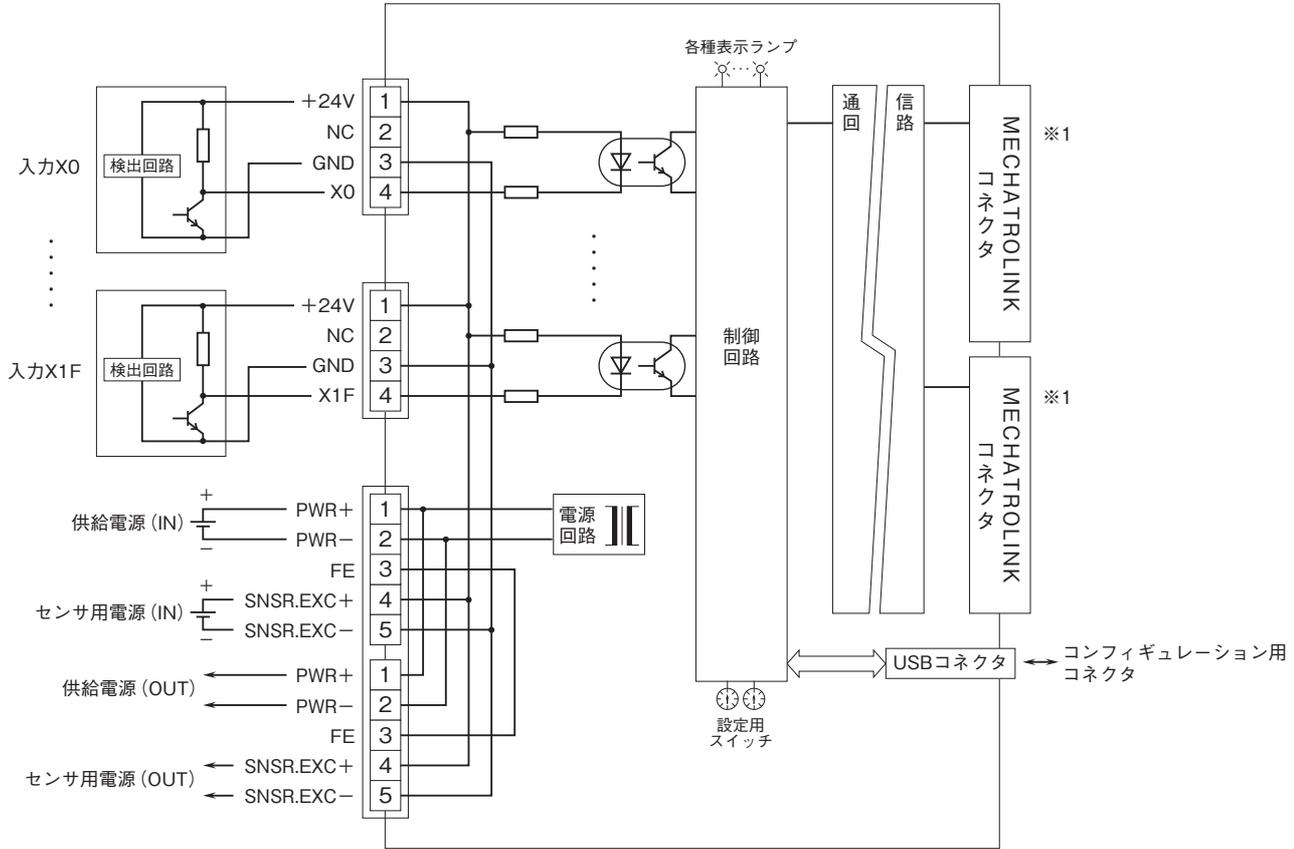
※1、MECHATROLINKコネクタは内部で接続されていますので、通信ケーブルはどちらにも接続できます。
