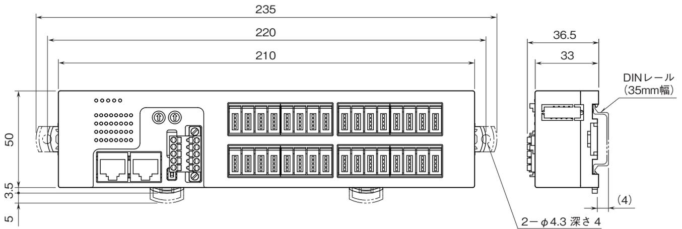
取付寸法図(単位:mm)
