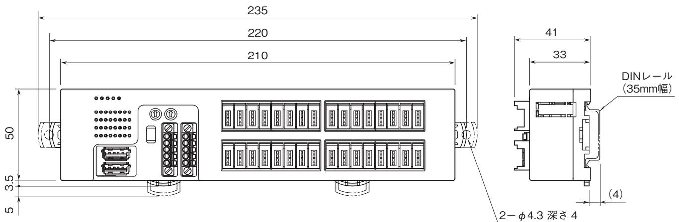
取付寸法図(単位:mm)
