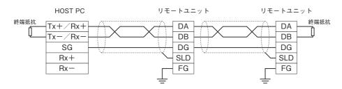
両端のユニットには、必ず同梱の"終端抵抗"を接続して下さい。また、"DA" — "DB"間に接続して下さい。マスタユニットは、両端以外へも接続できます。
