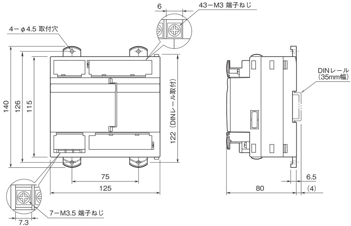
取付寸法図(単位:mm)
