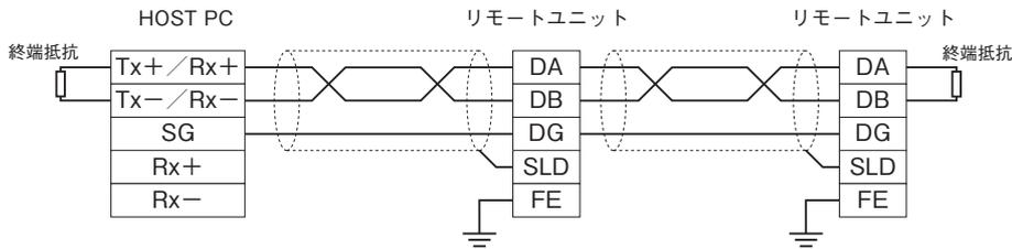
両端のユニットには、“DA” – “DB” 間に“終端抵抗”を接続して下さい。
