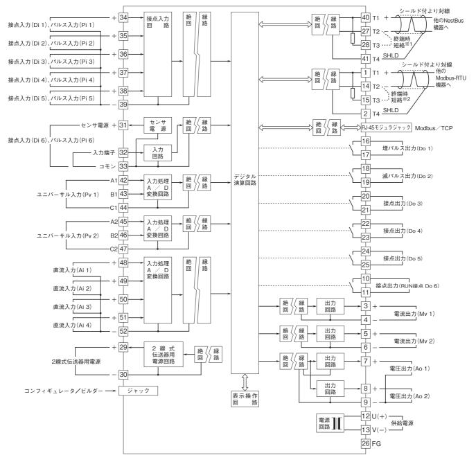
※1、ユニットが終端の場合は(渡り配線がない場合)、端子27、28間を短絡して下さい。 ※2、ユニットが終端の場合は(渡り配線がない場合)、端子14、15間を短絡して下さい。
