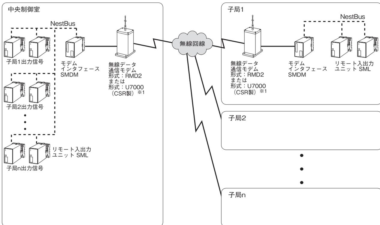
※1、ただし、無線データ通信モデムがご使用いただけるのは、同形式の組み合わせのみとなります。
