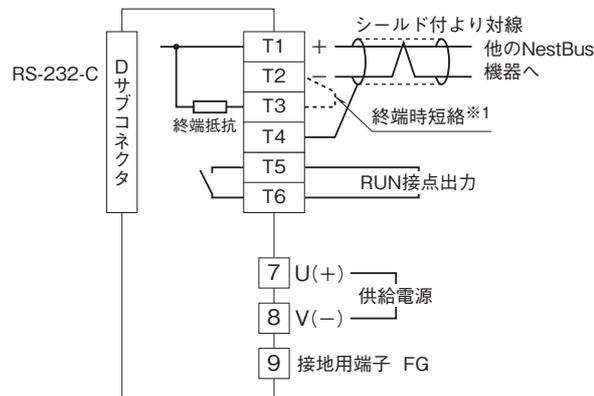
※1、より対線の伝送ラインが終端の場合は(=渡り配線がない場合)、端子T2、T3間を付属のショートチップ(または配線)で短絡して下さい。ユニットが伝送ラインの途中に配線されているときは、端子T2、T3間のショートチップをはずして下さい。
