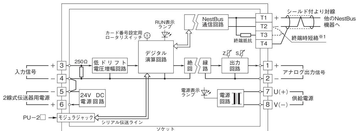
※1、より対線の伝送ラインが終端の場合は(=渡り配線がない場合)、端子T2、T3間を付属のショートチップ(または配線)で短絡して下さい。ユニットが伝送ラインの途中に配線されているときは、端子T2、T3間のショートチップをはずして下さい。
