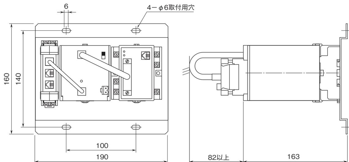
取付寸法図(単位:mm)
