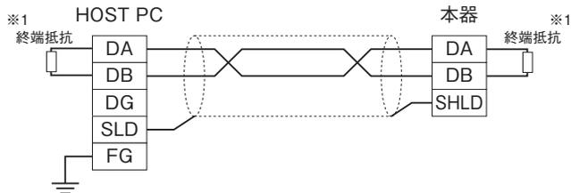
※1、内蔵の終端抵抗を使用する場合、終端抵抗設定用スイッチをONして下さい。
