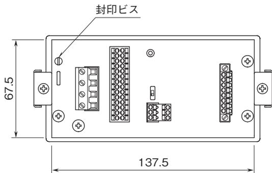
取付寸法図(単位:mm)
