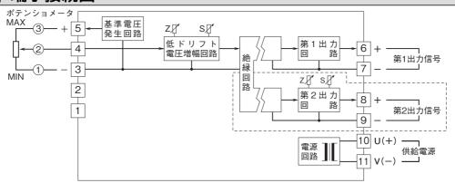
注)①、②端子には接続しないで下さい。 破線部は2出力形のときのみ付きます。
