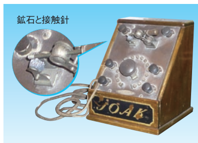
図2 放送開始ころの鉱石ラジオ (NHK放送博物館注) 所蔵
