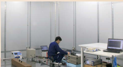
図4 シールドルーム
