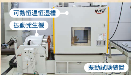
図5 温湿度・振動複合環境シミュレーションシステム
